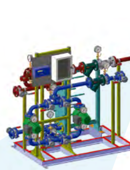
Модуль отопления Независимая схема с одним ТО и двумя насосами циркуляции отопления
